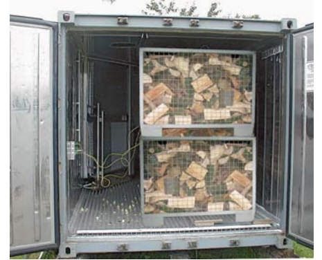
Standardgitterboxen für 1 srm Scheitholz im Containertrockner.
