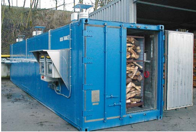
Standardgitterboxen für 1 srm Scheitholz im Containertrockner.
