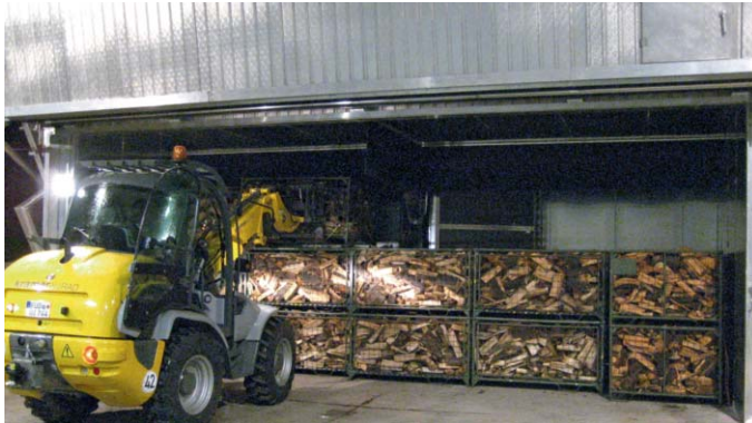
Remplissage d'une cellule de séchage avec des caisses grillagées standard.
