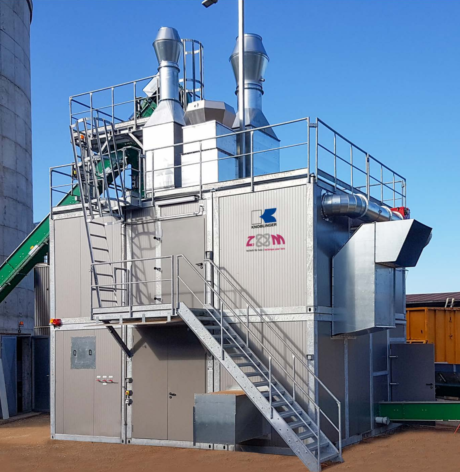
Pelletierung auf kleinstem Raum: Der PelletsCUBE. Bis zu 5 t/h Rohstoff (10–12 % F) gehackt, konditioniert, dosiert, gepresst, gekühlt, gesiebt und gefördert in Silo. Lärm- und Staubwerte nach Norm.
