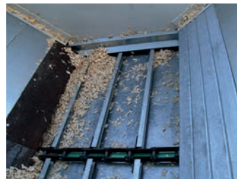
Transportboden im Vorlagebehälter
